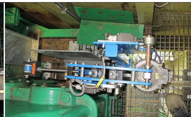
3. Remaandrijving is niet afgeschermd
